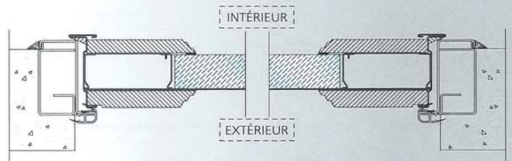
Nos portes vitrées sont pourvues d'un vitrage isolant retardateur d'effraction ainsi constitué:
