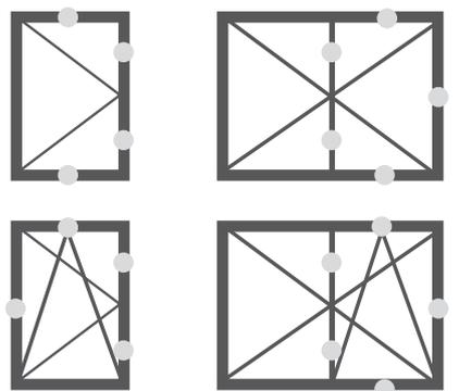
● Points de fermeture suivant largeur et hauteur
