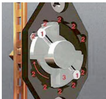
En poursuivant le mouvement de rotation, les goupilles de sécurité (1) sont entraînées par l'élément coupleur (3) vers d'autres évidements (2) dans lesquels elles s'engagent à nouveau en émettant un cliquetis parfaitement audible
